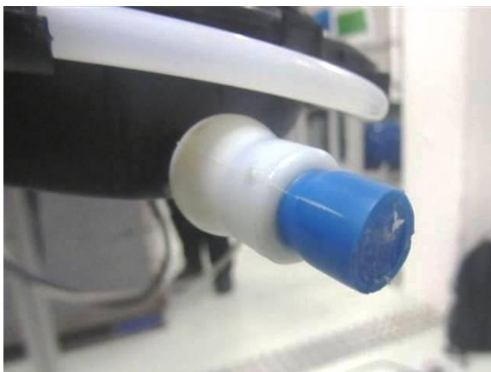
Рис. 5 (в качестве средства для закупоривания подойдёт отрезок водосточного шланга, заткнутый пробкой)
