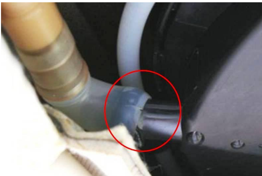
Рис. 2 (показано повреждение насадки водосточного шланга у монтажной рамы)
