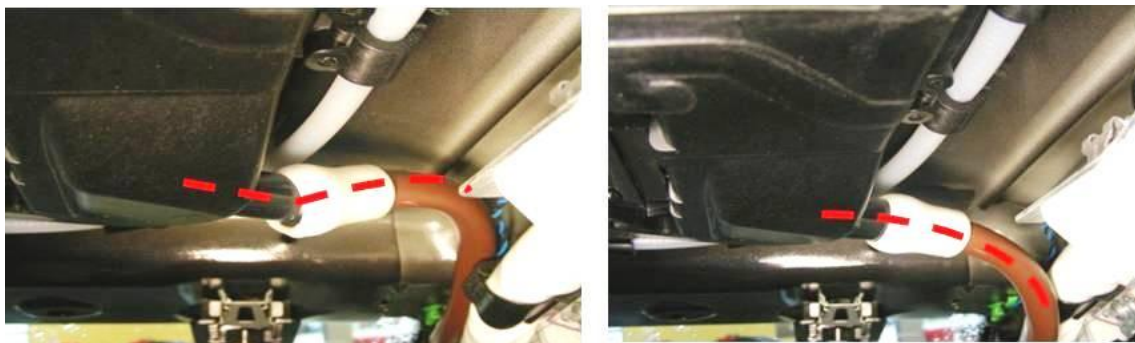
Рис. 4 (слева показано неправильное установочное положение, справа – правильное установочное положение водосточного шланга)
